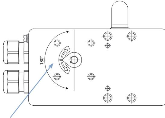
Die Drehbewegung der Sensorwelle muss innerhalb des Bereichs von max 180° liegen.
