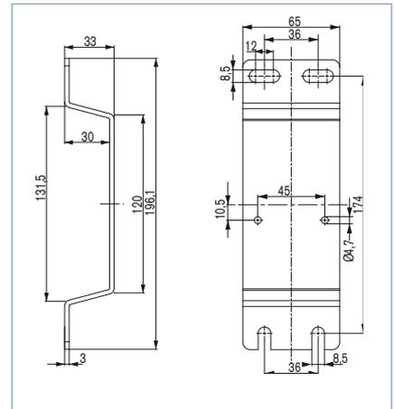
Montage an DIN-Schiene
